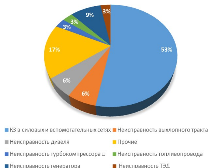
Рис. 2. Причины пожаров и аварий на железнодорожном транспорте
