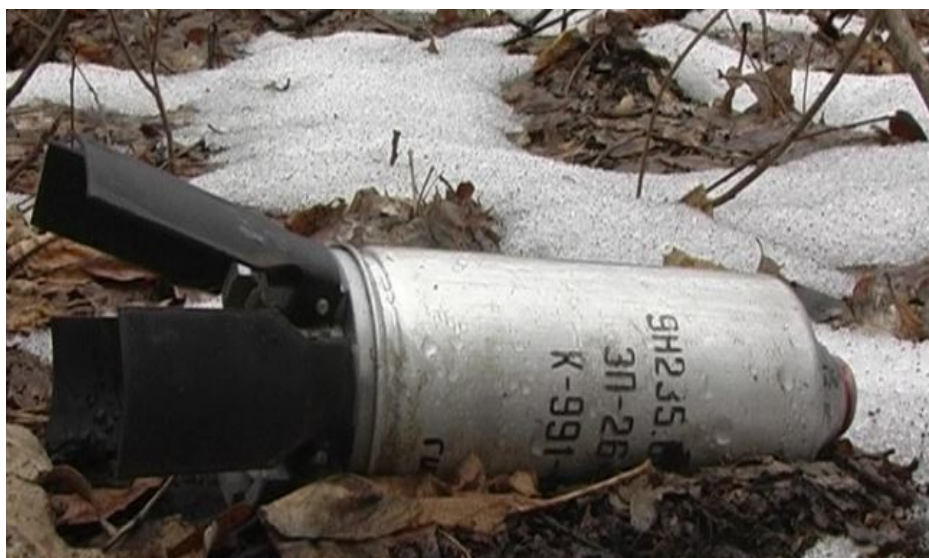
Рис. 4. Неразорвавшийся осколочный боевой элемент 9Н235 «Попрыгунья» (96 осколков массой 4,5 г, 360 осколков массой 0,75 г), широко применяемый Вооруженными силами Украины в кассетных снарядах РСЗО «Смерч» и «Ураган» на Востоке Украины
