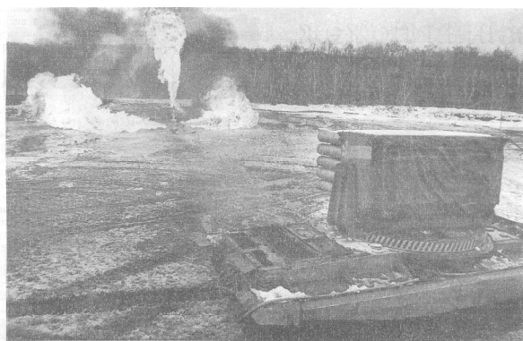
Рис. 1. Установка «Импульс-3» с дистанции 50 м здійснює прицілювання по багатофаксальному газовому фонтану дебітом 3 млн. м 3 /добу, тиск 120 атм.
