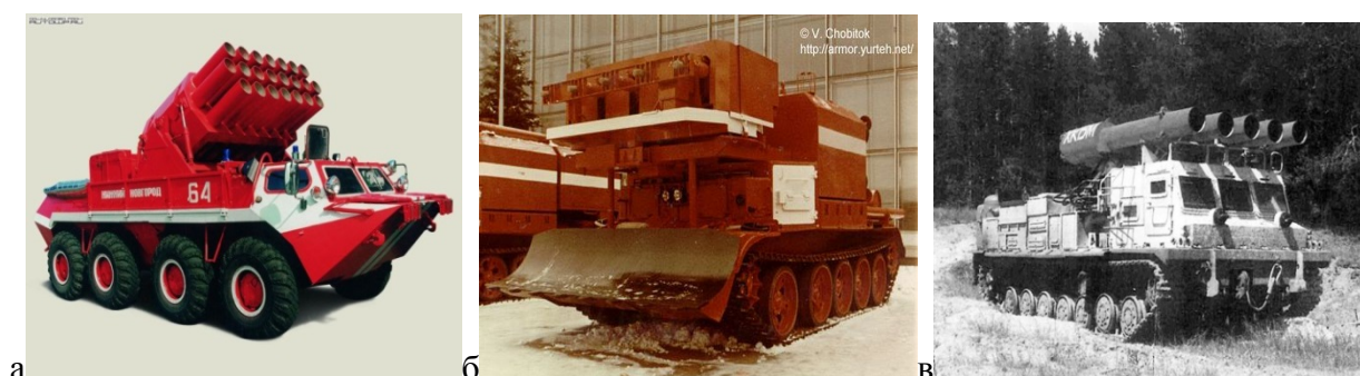
Рис. 3. а) импульсная 22-ствольная распыляющая порошок выстрелом и минизалпом двух стволов установка «Ветлуга» (производство ГАЗ); б) пятиствольная установка порошкового распыления воды на базе танковых огнеметов (ВНИИПО, Москва); в) пятиствольная пневмо-импульсная порошковая установка (г. Харьков, завод им. Малышева)
