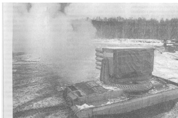
Рис. 2. Багатофаксальний високодебітний газовий фонтан загашено з дистанції 50 м одним залпом.
