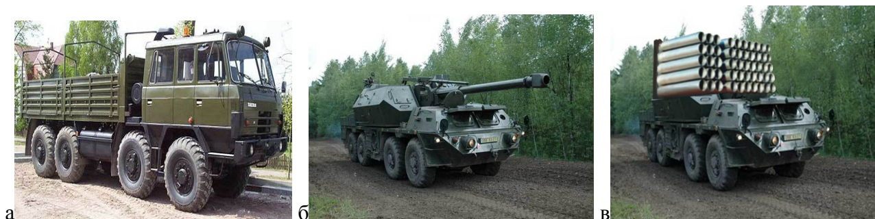
Рис. 5. а) шасси тяжелого грузового автомобиля «Татра-Колос»; б) САУ «Дана»(Сюзанна); в) эскиз монтажа ММ-50 на шасси «Дана»
