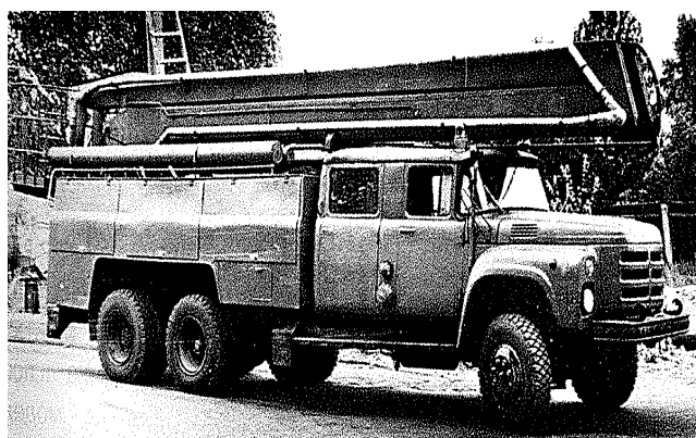
Рис. 5. Пожарный автомобиль на шасси ЗИЛ-133ГЯ, совмещающий в себе автоподъемник и пожарную цистерну
