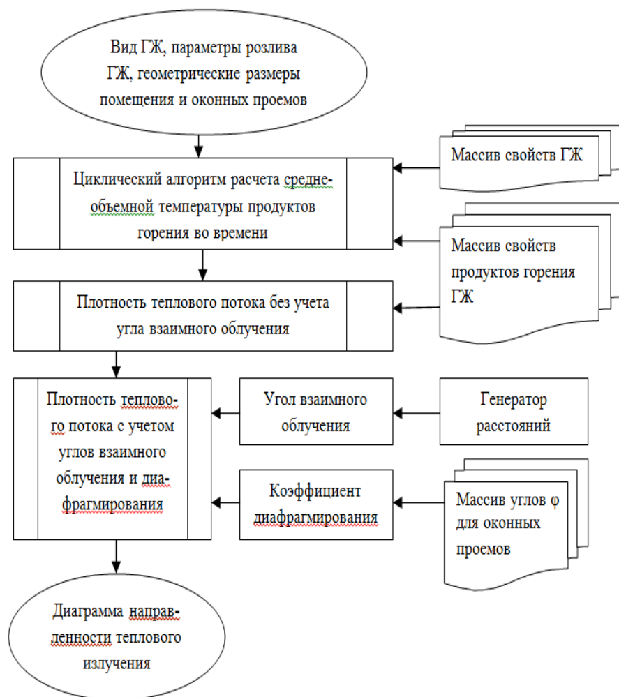
Рис. 2. Алгоритм расчета диаграммы направленности через проемы в ограждениях при пожаре на объектах нефтехимического комплекса
